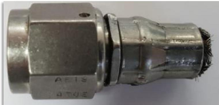
Figura G – Tubo flexível extremidade não danificada
