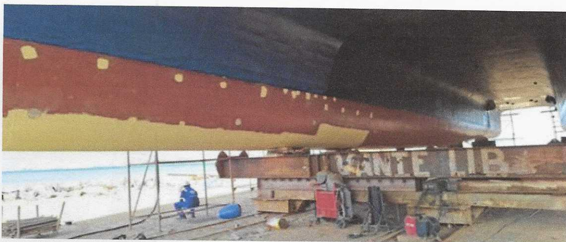
Figura 11 - Vista das chapas substituídas no fundo do flutuador de EB
