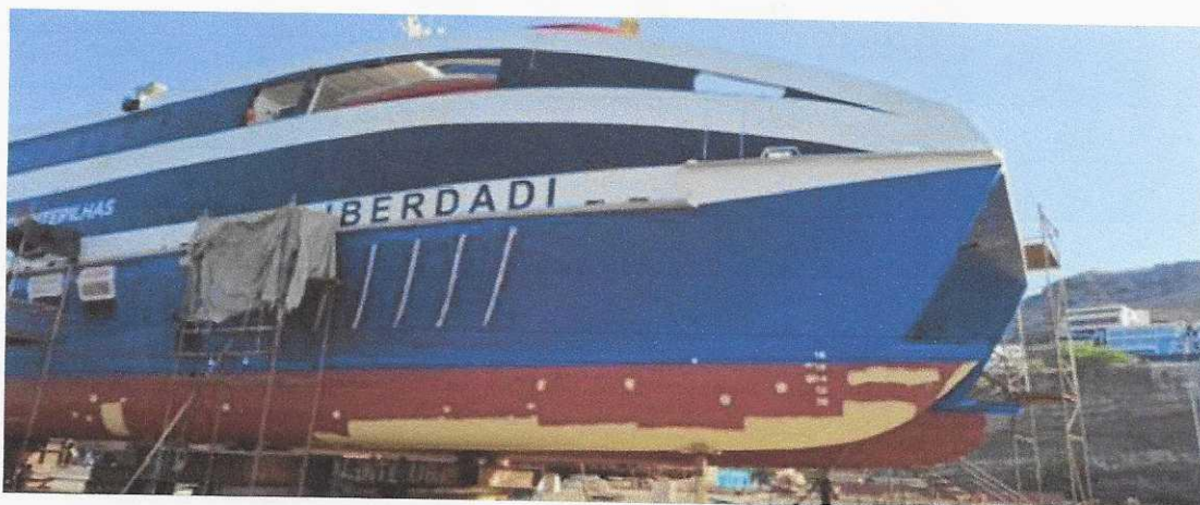
Figura 12 - Vista das chapas substituídas do lado externo do flutuador de EB
