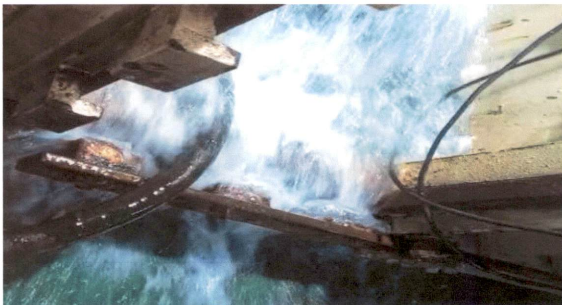
Figura 12: Entrada de água no túnel de ligação da casa da máquina do leme à casa das máquinas, em viagens anteriores a docagem do “N/M NHÔ PADRE BENJAMIM”. Fonte: Arquivos dos tripulantes anteriores.
